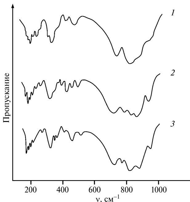
Рис. 2. ИК-спектры \alpha - \text{KSm}(\text{MoO}_4)_2 (1), \text{KSrSm}(\text{MoO}_4)_3 (2), \text{KSrGd}(\text{MoO}_4)_3 (3).
