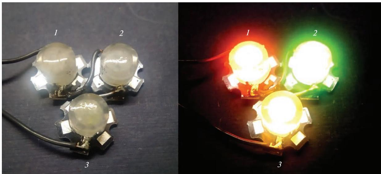
Рис. 14. Макеты излучателей, созданных с применением промышленных УФ-LED-источников и кристаллов  $\text{La}_{0.58}\text{Eu}_{0.42}\text{MgB}_5\text{O}_{10}$  (1),  $\text{La}_{0.29}\text{Tb}_{0.71}\text{MgB}_5\text{O}_{10}$  (2),  $\text{La}_{0.19}\text{Eu}_{0.04}\text{Tb}_{0.77}\text{MgB}_5\text{O}_{10}$  (3).
