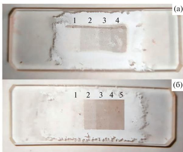
**Рис. 2.** Общий вид образцов порошка BGO после лазерной обработки в режимах I (а) и II (б), цифрами обозначены поля с различным количеством проходов (а) и поля с различным временем экспозиции (б).
