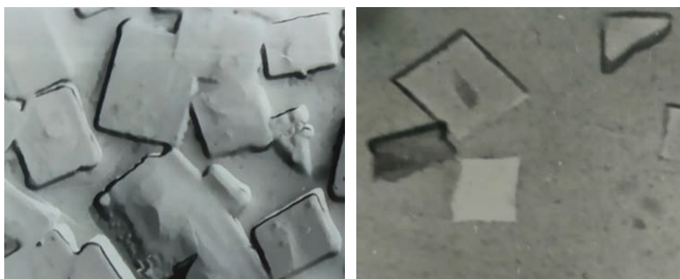
Рис. 6. Микрофотографии синтезированного образца \text{MgAl}_2\text{O}_4 + 1.5\% \text{ Eu}_2\text{O}_3 ; \times 4500 .
