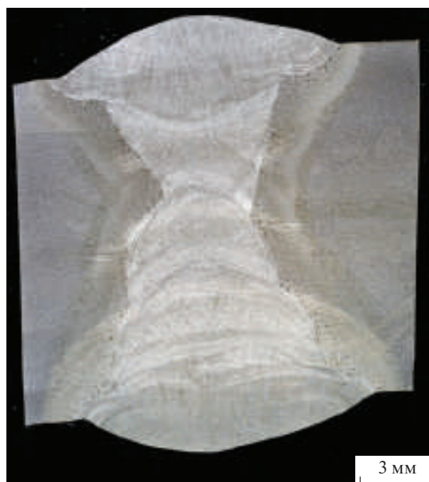
Рис. 1. Общий вид сечения сварного шва.
