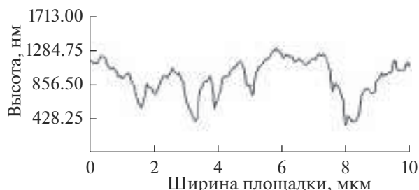
Рис. 2. Профилограмма поверхности кварцевых стержней.
